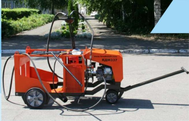
Обладнання призначене для автоматичного розбрізкування сполучних речовин (бітумної емульсії) на поверхню дороги при проведенні незначного ямкового ремонту дорожнього полотна, герметизації швів і тріщин перед укладанням асфальто-бетонних сумішей, при експлуатації на відкритому повітрі при температурі від +5 °C до + 40 °C. Ємність з бітумною емульсією в комплект поставки обладнання не входить.
