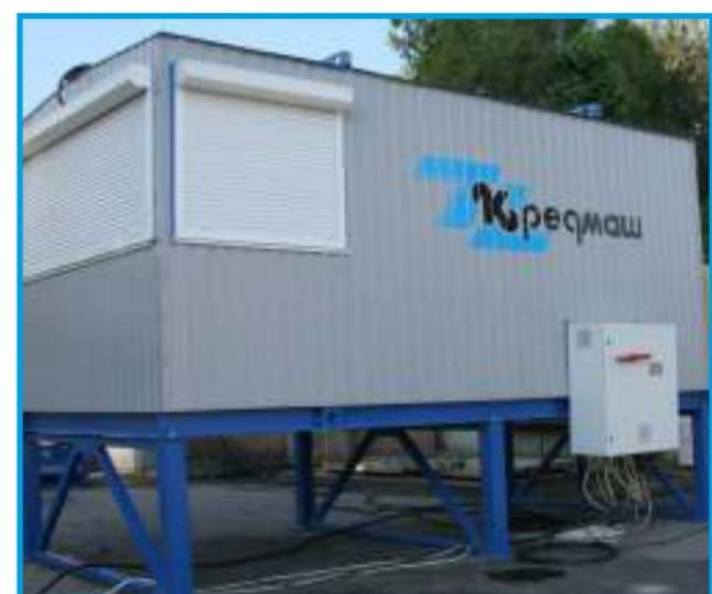
Асфальтозмішувальною установкою управляє комп'ютерна система розподіленого типу з виносними шафами, оснащеними вбудованою системою клімат-контролю. Все електрообладнання виконано на базі комплектуючих європейських виробників.
