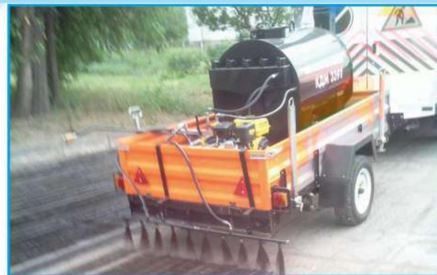
Малогабаритный гудронатор — это оборудование для разлива (разбрызгивания) битумной эмульсии на дорожное полотно перед укладкой асфальтобетонных смесей, а также для обработки ямок и трещин разбрызгивателем вручную. Оборудование устанавливается и закрепляется болтами к полу легкового автомобильного прицепа и транспортируется автомобилем со снаряженной массой не менее 900 кг.
