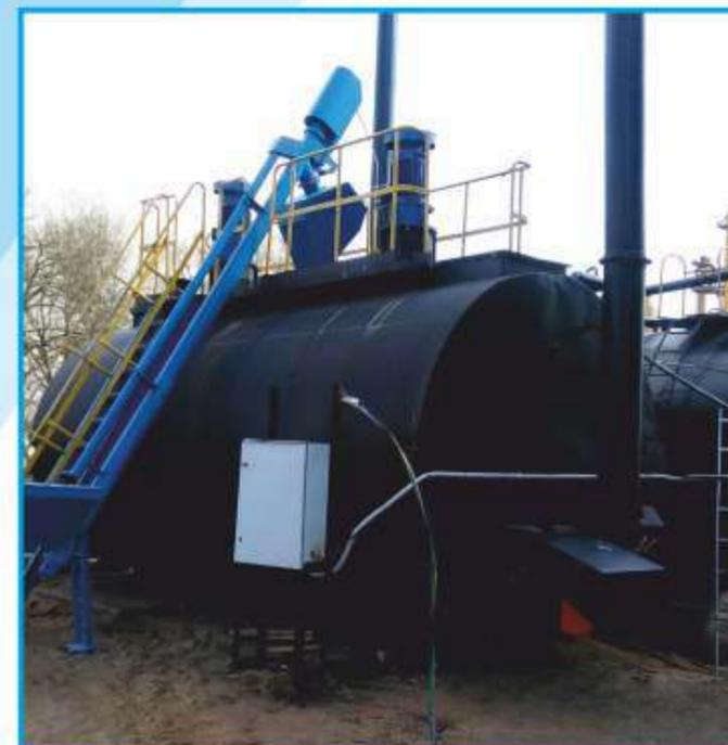
Цистерна битумосмесительная КДМ221 предназначена для приготовления модифицированных битумов с использованием твёрдых дисперсных, порошкообразных и жидких добавок в составе АБЗ и битумных баз. Изготавливаются цистерны емкостью 30 м<sup>3</sup> с двумя перемешивающими устройствами и с нагревом битума от жаровой трубы или от эшевика.
