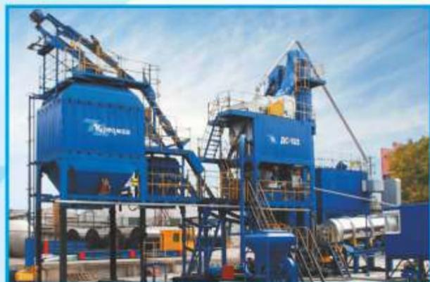
Асфальтосмесительная установка ДС-185У, мобильная, партерного типа. Производительность — 64 т/ч
