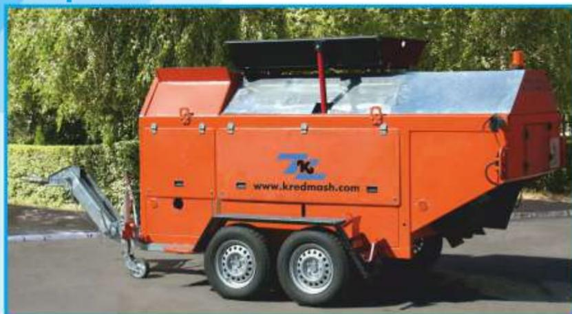
Регенератор асфальта предназначен для приготовления асфальтобетонной смеси при проведении ямочного ремонта дорожного полотна в непосредственной близости от места ремонта
