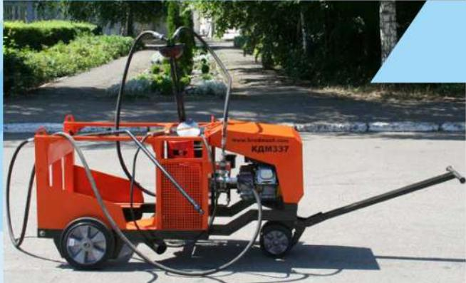
Обладнання призначене для автоматичного розбрязкування сполучних речовин (бітумної емульсії) на поверхню дороги при проведенні незначного ямкового ремонту дорожнього полотна, герметизації швів і тріщин перед укладанням асфальто-бетонних сумішей, при експлуатації на відкритому повітрі при температурі від +5 °C до + 40 °C. Ємність з бітумною емульсією в комплект поставки обладнання не входить.
