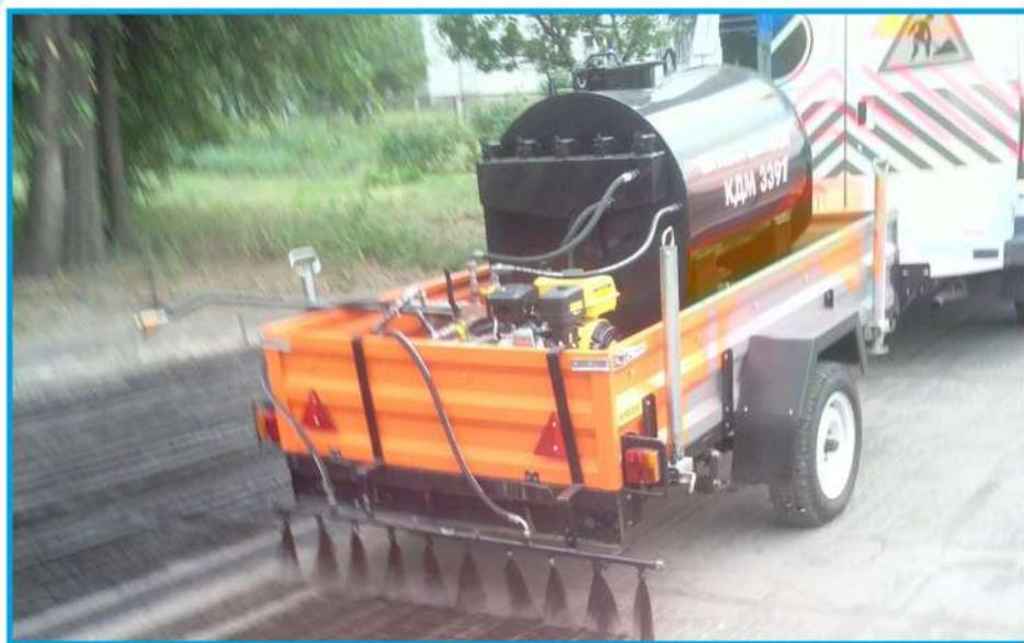
Малогабаритний гудронатор — це обладнання для розливу (розбрізкування) бітумної емульсії на дорожнє полотно перед укладанням асфальтобетонних сумішей, а також для обробки ямок і тріщин розприскувачем вручну. Обладнання встановлюється і закріплюється болтами до підлоги легкового автомобільного причепа і транспортується автомобілем зі спорядженою масою не менше 900 кг.
